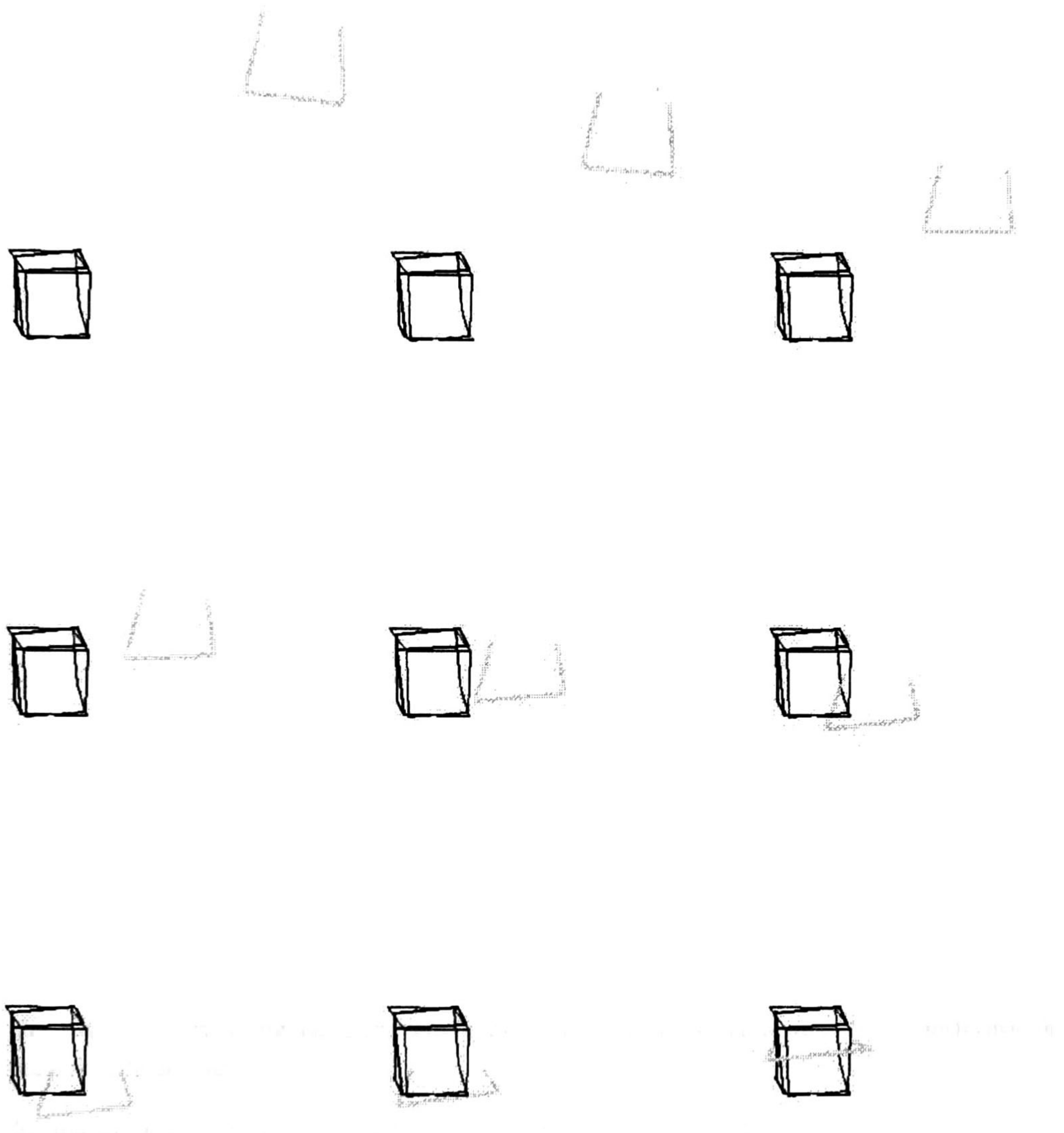
Figura 5.13: Trayectoria que deberá seguir la pinza para sujetar el cubo.
