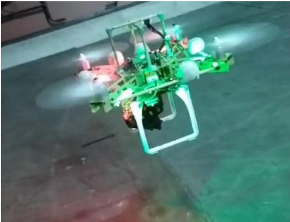
Figura 5.9: Vuelo de prueba del VANT con el manipulador como carga no modelada. <https://youtube.com/shorts/iEQ39ZJoMDQ>
