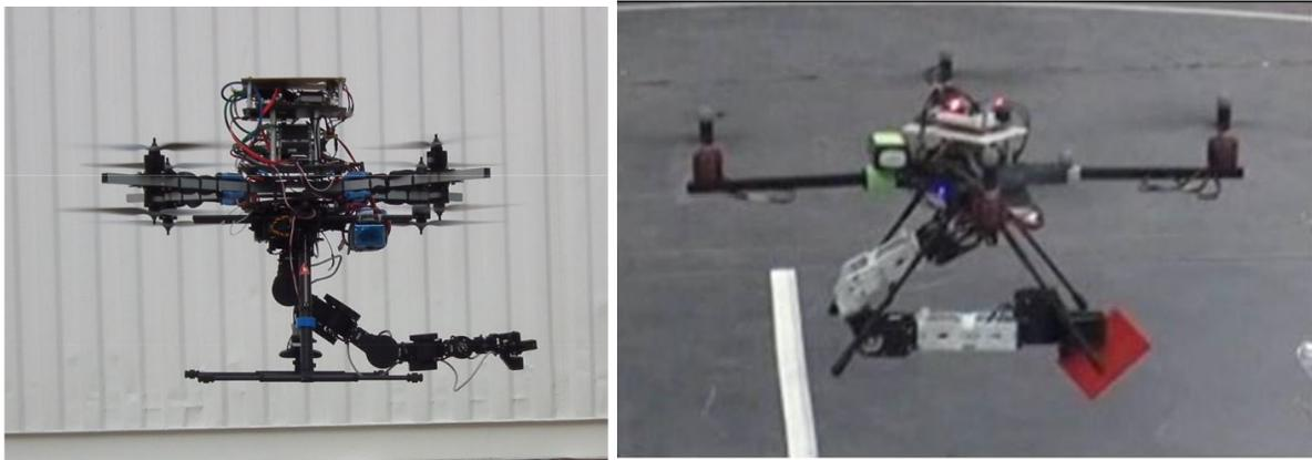
(a) Octorotor, AMUSE, con manipulador de 7 grados de libertad, tomado de [8]. (b) Cuatrirotor, con brazo manipulador de 2 grados de libertad, tomado de [9].
