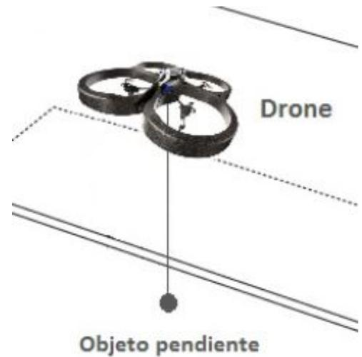
(b) Cuatrirotor con una carga suspendida mediante un cable.
