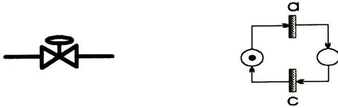
Figura 3.6: Modelo de un Actuador con Evolución Secuencial
