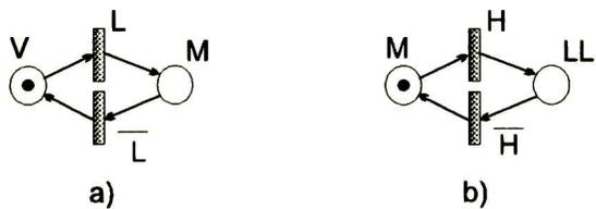
Figura 3.3: Modelos de Sensor: a) bajo nivel b) alto nivel
