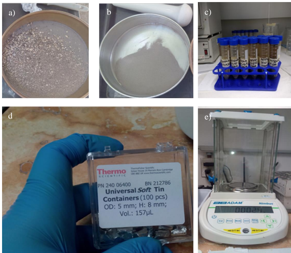
Figura 37.- Proceso para la determinación de isótopos estables a). Tamizado; b) acidificación; c) capsulas de estaño; d) pesado de muestras.
