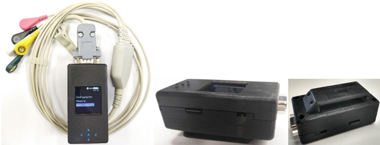
Fig. 3. 20 Monitor ambulatorio de ECG final.
