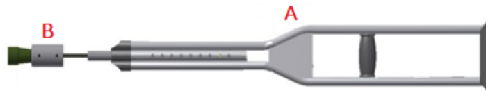
Figura 11.-Muletas amortiguadas; (A) Modulo electrónico; (B) Modulo amortiguador.
