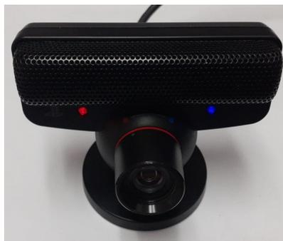
Figura 3.5: Cámara de la PlayStation 3 utilizada para generar la base de datos.
