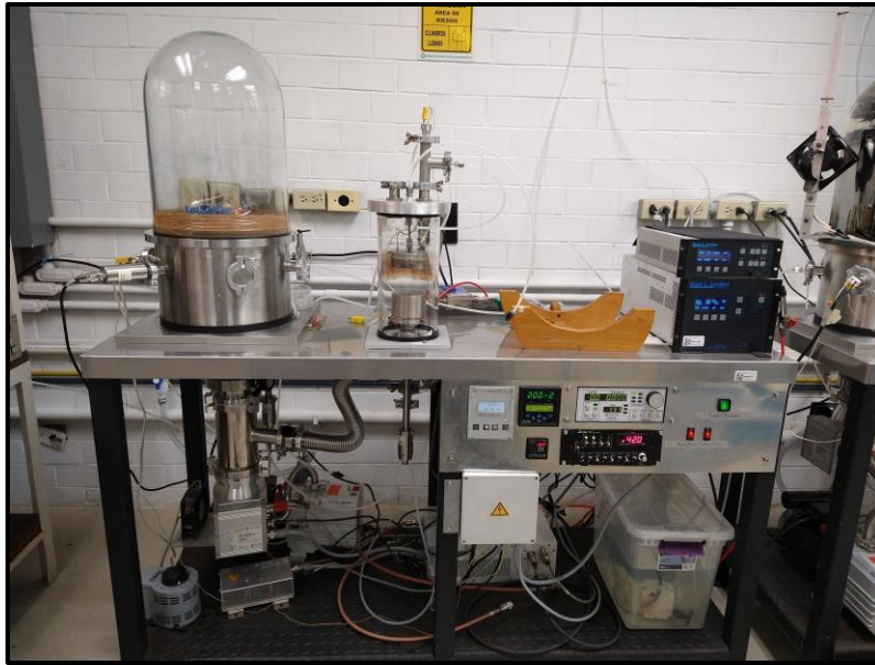
Figura 3.1.- Equipo empleado para el depósito de películas delgadas por la técnica RF-Sputtering.
