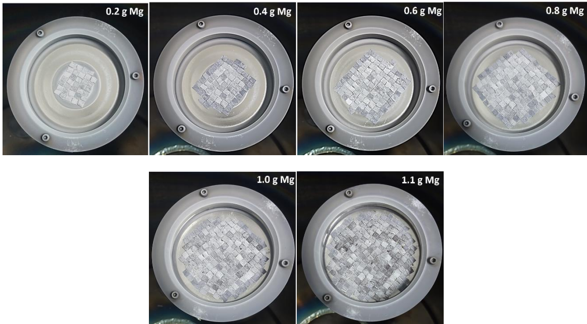
Figura 3.3.-Target con diferentes cantidades de virutas de Mg.
