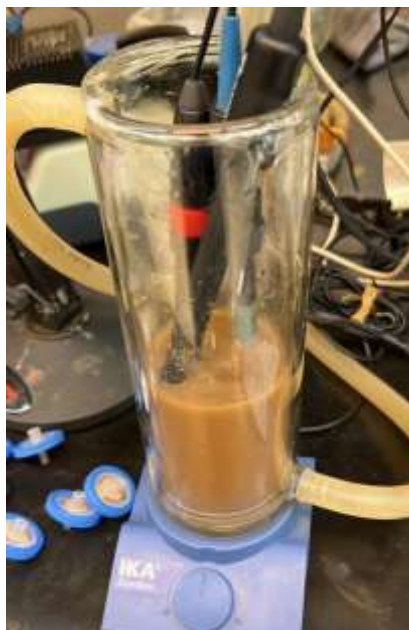
Figura 6. Arreglo experimental del equipo utilizado para la cianuración del mineral.
