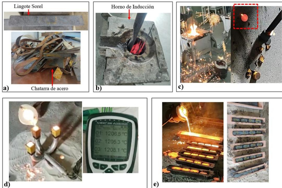
**Figura 2.1. Procedimiento experimental para la obtención del metal base: a) materia prima, b) carga metálica en horno de inducción para su fusión, c) toma de muestra del metal líquido para análisis químico, d) vaciado de copas para análisis térmico y e) vaciado del metal base en lingoteras.**
