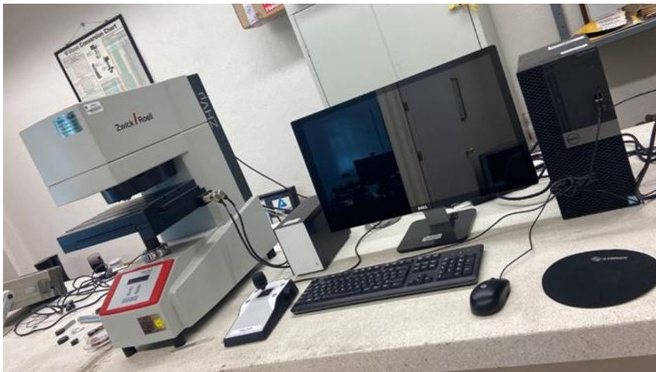
Figura 25. Equipo Zwick/Roell modelo ZHv $\mu$  para microdureza Vickers.
