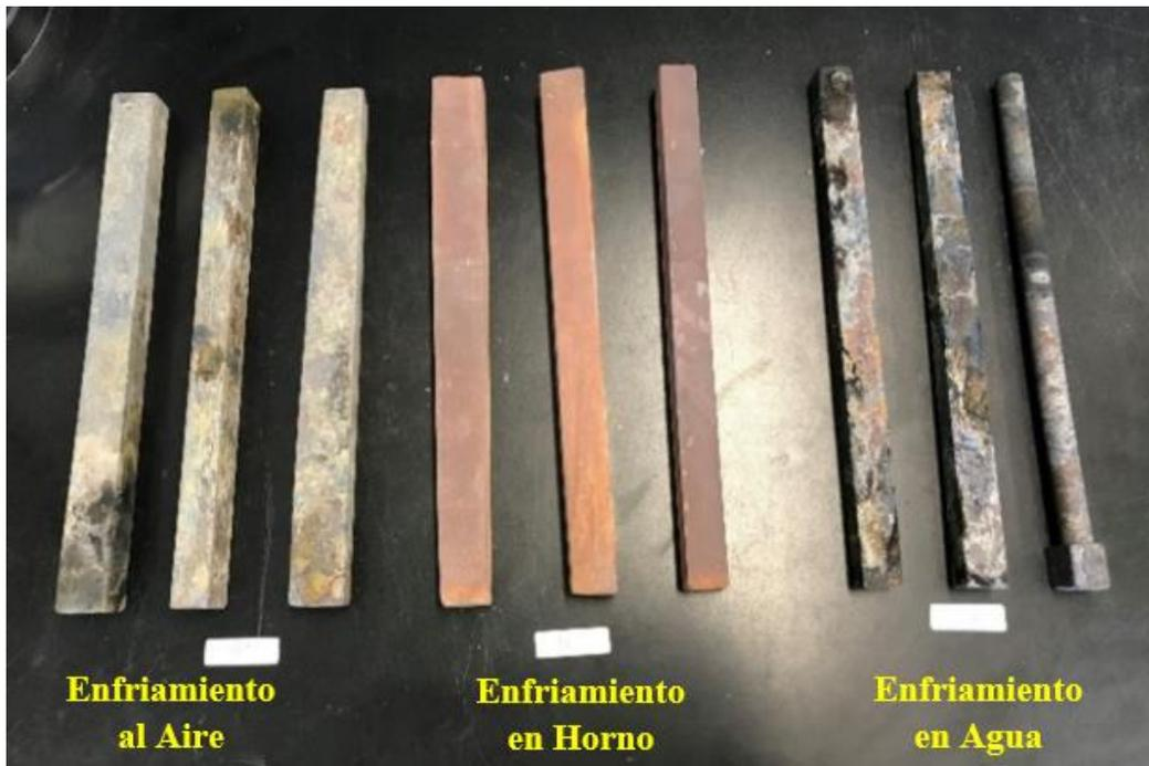
Figura 12. Muestras de Ti-407 posterior a tratamiento térmico de solución.
