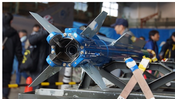
Figura 2.10: Vista trasera del Thrust Vector Control del misil AAM-5 Kai [13]
