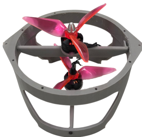
Figura 6.14: Base para soportes de motores con las hélices ensambladas
