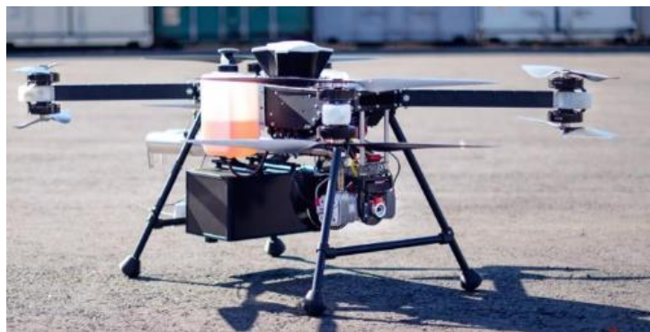
Figura 2.4: Airborg H8 10K con sistema de energía híbrido en serie.
