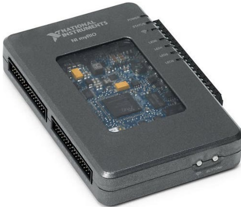
Figura 3.16: Dispositivo Embebido NI myRio.
