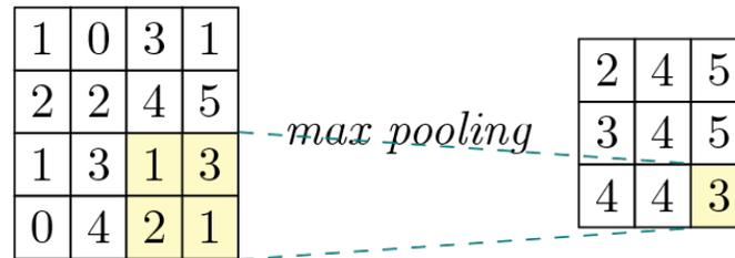
Figura 2.23: *Max pooling* con un filtro  $2 \times 2$  y *stride* de 1.
