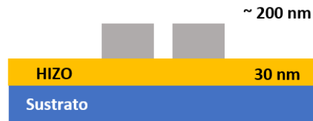
Fig. 2.3. Corte transversal de la estructura para determinar la conductividad de la capa de HIZO.
