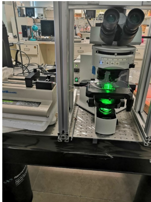
Figura 3.5: Montaje experimental. En la parte izquierda de la figura se observa una bomba de jeringa, el microscopio y la fluorescencia encendida.
