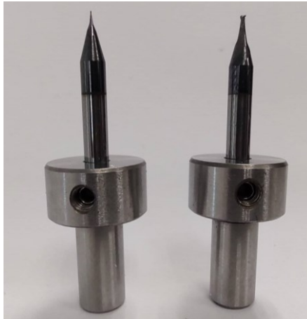
Figura 18. Brocas empleadas para el micromaquinado del dispositivo microfluídico montadas sobre adaptador para la fresadora. La broca de la izquierda corresponde a la broca de 200 \mu\text{m} , con la cual se realiza el rectificado de la superficie y se maquinan la constricción de 5 \mu\text{m} de altura y los microcanales. La broca de la derecha corresponde a la broca de 800 \mu\text{m} que se emplea para el micromaquinado de la entrada única y las salidas, así como el pocillo alineador.
