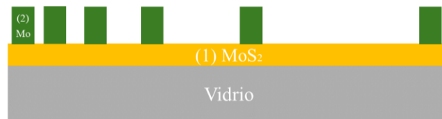
Figura 8. Estructura MS - muestra testigo 1.
