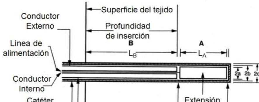
Fig. 7 Antena tipo Dipolo. Construida a partir de un cable coaxial con tres regiones: ranura, extensión e inserción
