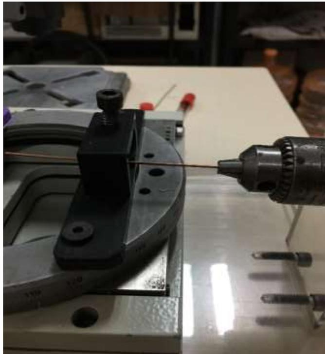
Fig. 10 coaxial colocado en la boquilla del torno.
