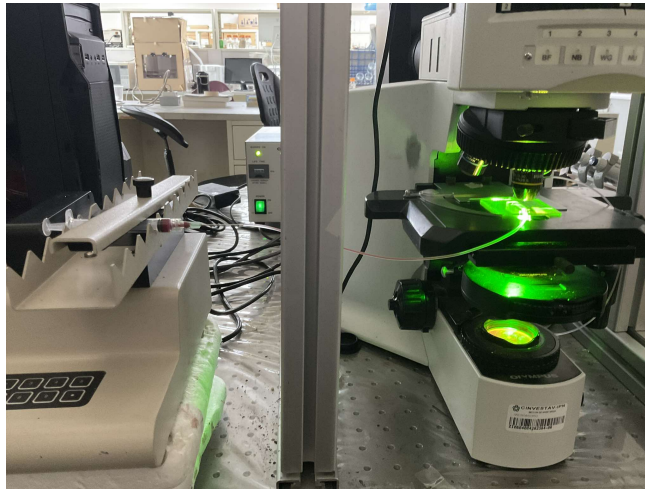
Figura 5.7: Montaje Experimental. De izquierda a derecha se puede observar la bomba de jeringa y el dispositivo montado en la platina del microscopio con la luz de fluorescencia encendida. Elaboración propia.
