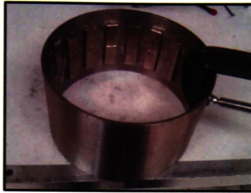
Fig. 10-5. Adhesión de los imanes
