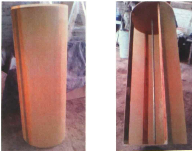
Fig. 10-8. Molde para la fabricación de los alabes.
