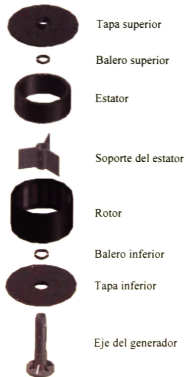
Fig. 10-6. Ensamble del GSIP
