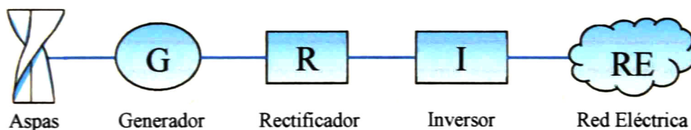
Fig. 8-1. Cadena de generación del aerogenerador
