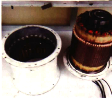
Fig. 14-11. Rotor y estator del GSIP de 5 kW
