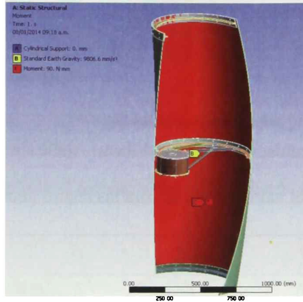
Fig. 9-17. Cargas aplicadas en el alabe.
