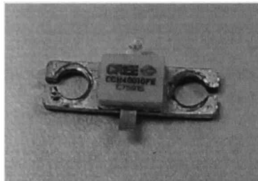
Fig. 5.2 Transistor HEMT GaN CGH40010 del fabricante CREE.
