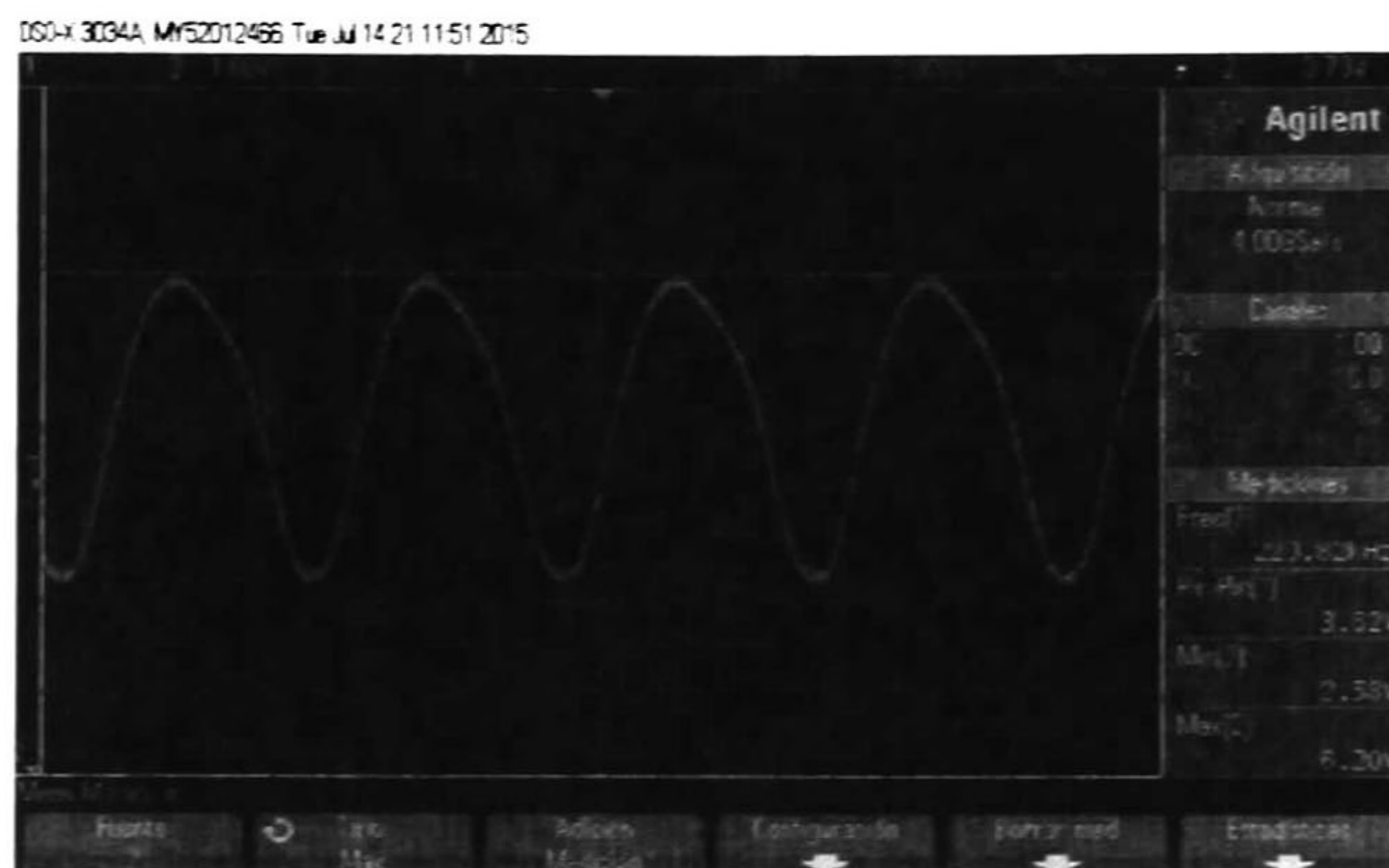
Fig.4.14. V_{out} con una n=4 y R_B = 660\Omega
