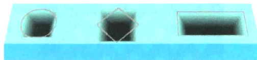
Fig. 4. 1 Grabado anisotrópico en una oblea de silicio (100) con máscaras en diferentes orientaciones.
