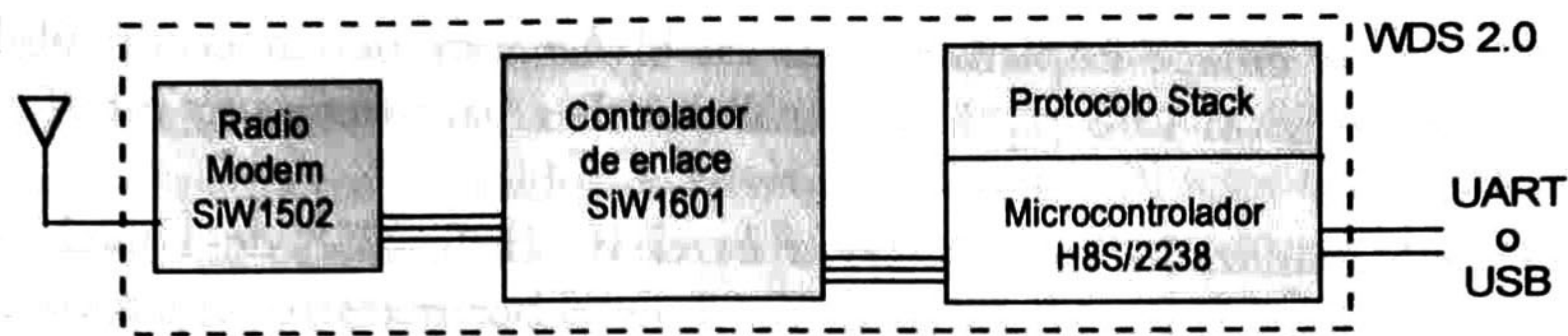
Figura C.1 Diagrama a bloques del Sistema de Desarrollo Inalámbrico WDS 2.0.
