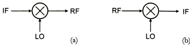
Fig. 4.2 Representación de un mezclador para conversión up/down .
