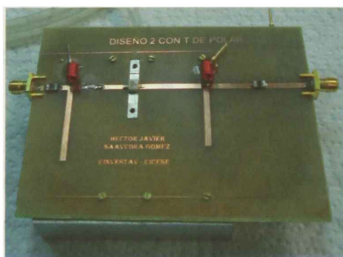
Fig. 5.1 amplificador de potencia clase AB implementado.
