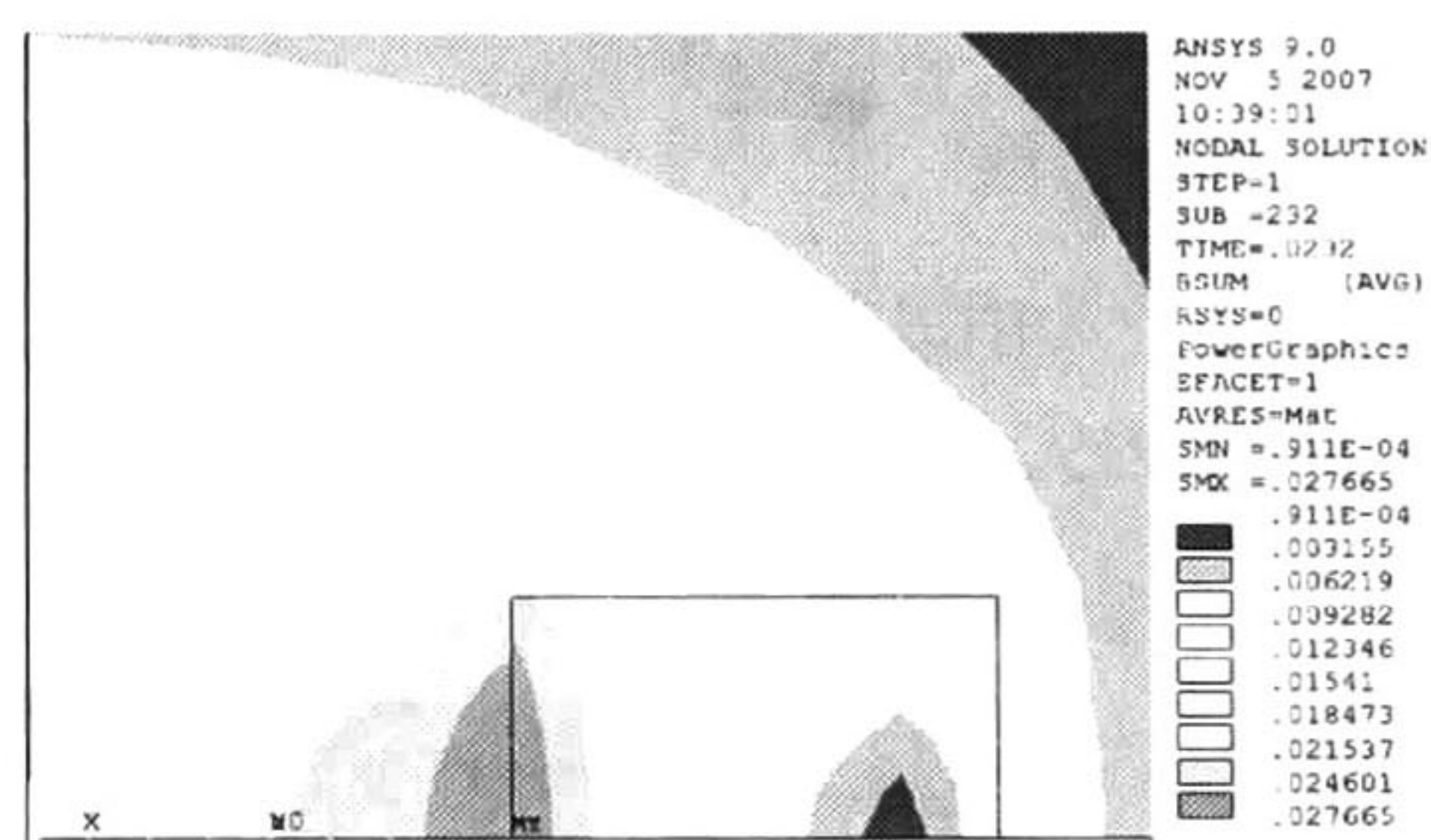
Figura 5.11: Densidad de flujo magnético en t = 0.0232 s axisimétrico.
