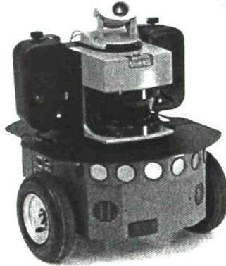
Figura 2.2: Robot Pioneer P3-DX.
