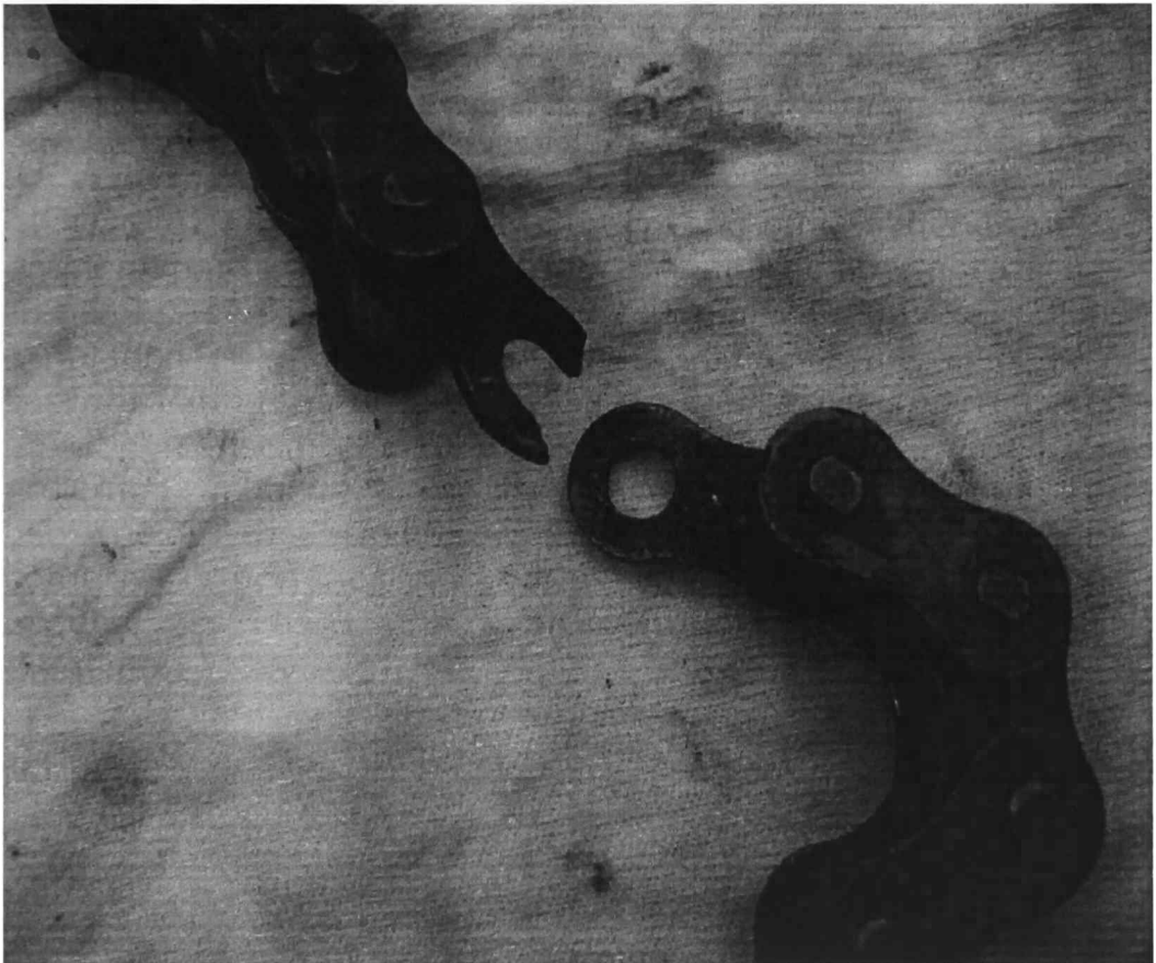
Fig. 3 Daño en la cadena
