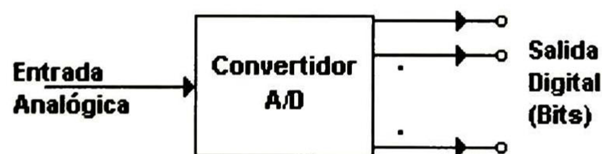
Figura 2 Convertidor Analógico-Digital de n bits en paralelo [6].
