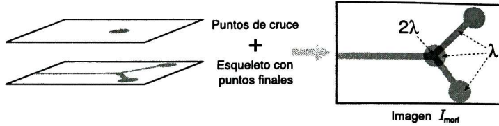
Figura 4.17: Formación del esqueleto y puntos finales utilizado en el postprocesamiento.
