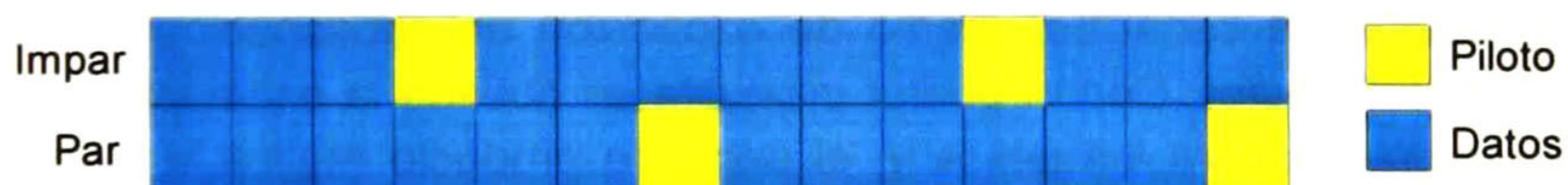
3.32 Patrón de pilotos para interpolación pasa bajas
