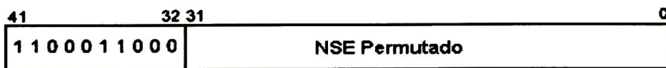
Máscara del código largo público para canales de los canales de tráfico
