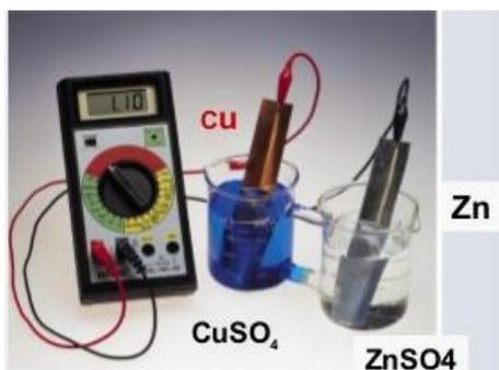
Fig. 1.10 Celda voltaica Cobre-Zinc
