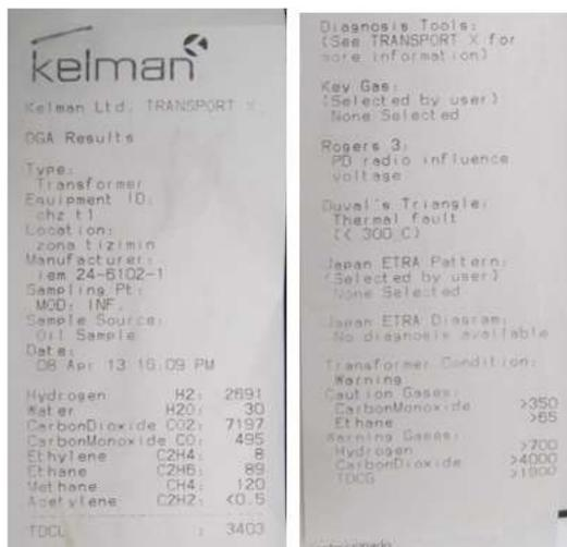
Figura 5.1.2.5. Resultados del análisis con la concentración de cada uno de los gases
