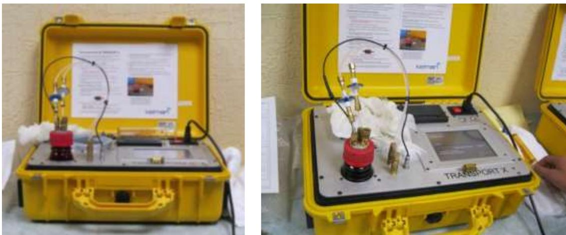
Figura 5.1.2.1. Equipo Kelman para análisis de Contenido de Gases
