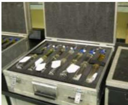
Figura 5.1.2.2. Jeringas con muestras de aceite del transformador
