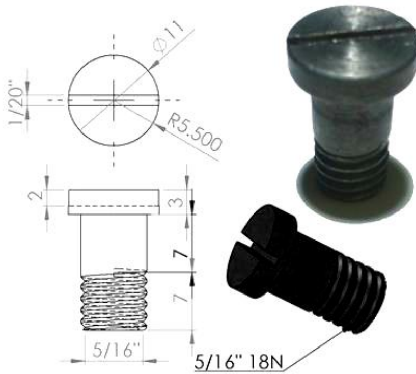
Fig. A1.3. Diagrama y fotografía del tornillo sujetador balero y cubo.
