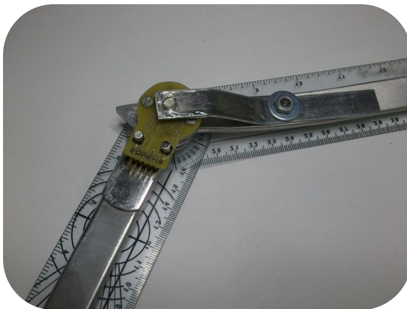
Fig. 4.16. Sensor AS5040 con goniómetro comercial.
