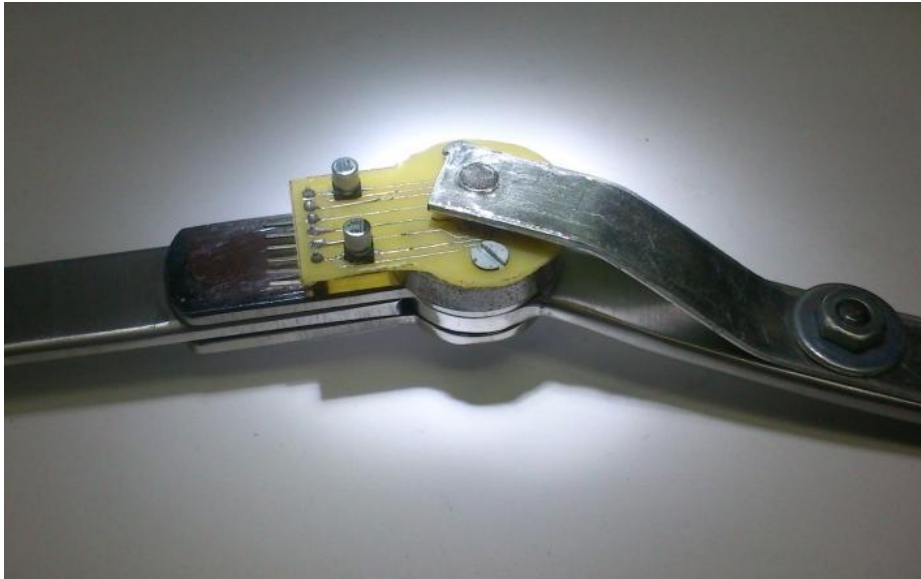
Fig. 3.12. Articulación con el encoder .
