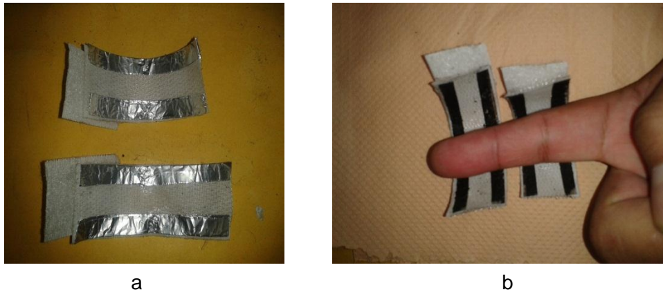
Fig. 52. Montaje de los electrodos para una configuración tetrapolar
