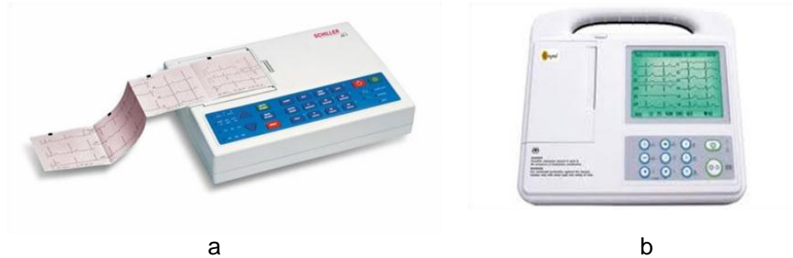
Fig. 15. Electrocardiógrafos comerciales, analógico (a) y digital (b)
