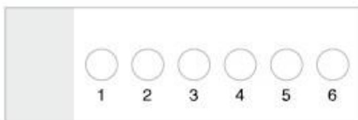
Figura 7.1. Kit TetraSpeck™. Micro-esferas de diferentes tamaños en un portaobjetos, la posición 1 con un tamaño de 4 \mu\text{m} ; 2ª posición de 1 \mu\text{m} ; posición 3 de 0.5 \mu\text{m} ; posición 4 de 0.2 \mu\text{m} ; posición 5 de 0.1 \mu\text{m} y posición 6 contiene la mezcla de todas las anteriores.
