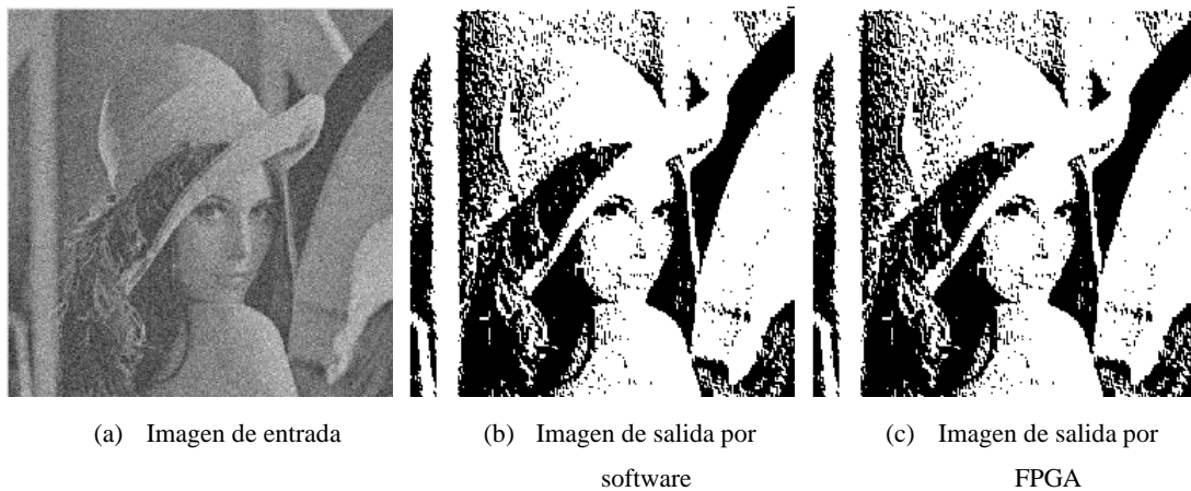
Fig. 2.11. Imagen real procesada en software y FPGA para reducción de ruido.
