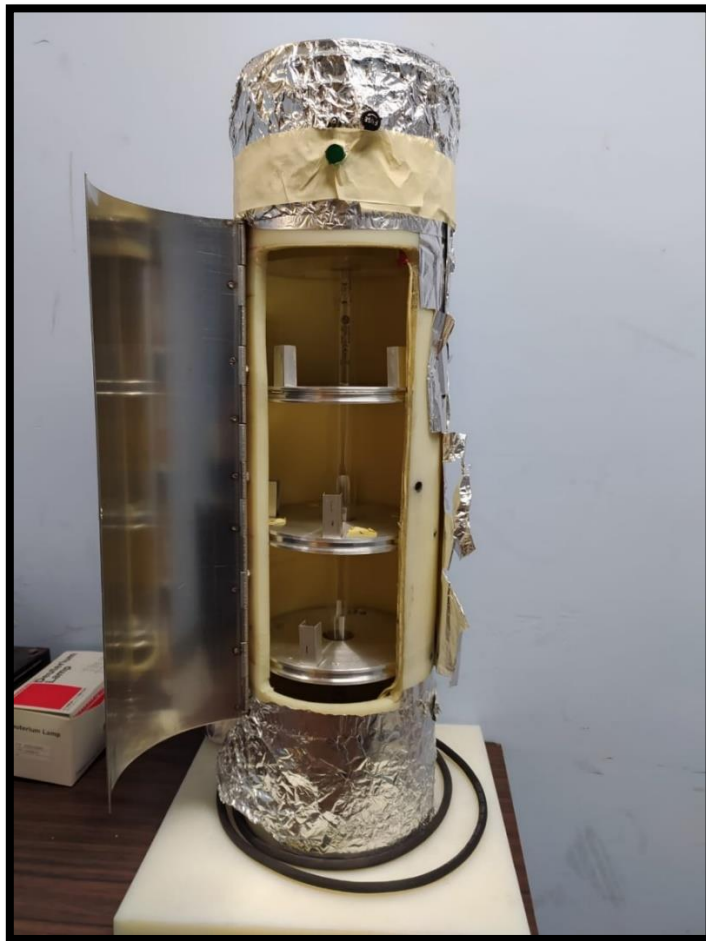
Figura 22 Reactor de luz ultravioleta para pruebas de fotodegradación.
