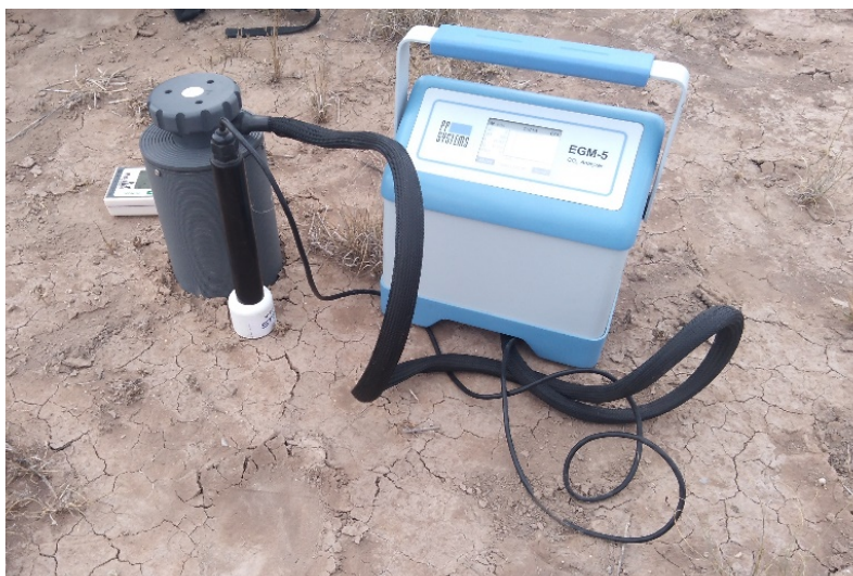
Figura 13. Equipo EGM-5 (PP Systems, USA) con cámara dinámica SRC-2 y el sensor Hydraprobe II (Stevens) en el sitio de estudio.
