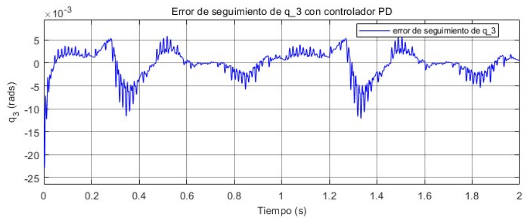
Figura 4.3: Error de seguimiento de la rodilla usando PD para estabilizar el sistema en la identificación de parámetros.
