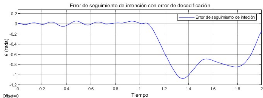
Figura 5.9: Error de seguimiento de intención en la implementación del EGHLC en lazo abierto
