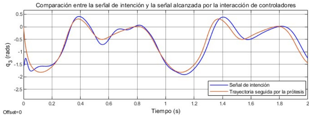
Figura 5.11: Comparación de señales en la implementación del EGHLC en lazo cerrado
