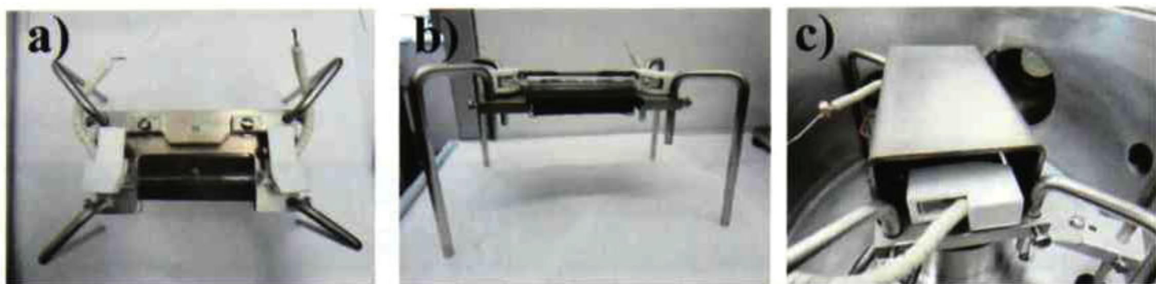
Figura 5.4. Plato de acero inoxidable ya fabricado, con piezas colocadas a) vista superior, b) vista frontal c) barrera térmica.
