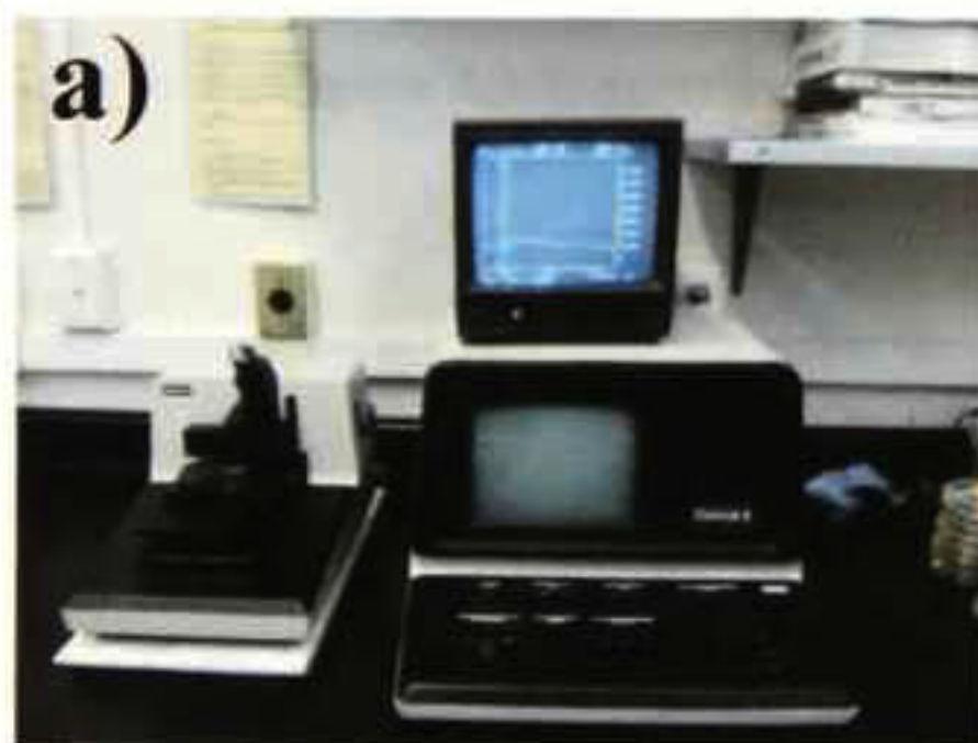
Figura 4.2. a) Perfilómetro Dektak II, b) Esquema de funcionamiento.
