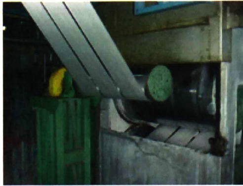
Figura 5. Tres Cables de 350,000 filamentos
