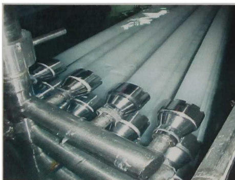
Figura 3. 8 espreas dentro de un baño de solución formando un cable.
