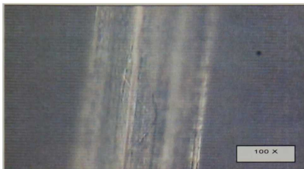
Figura 42. Microscopía óptica aplicada a la fibra precursora rectangular oxidada.
