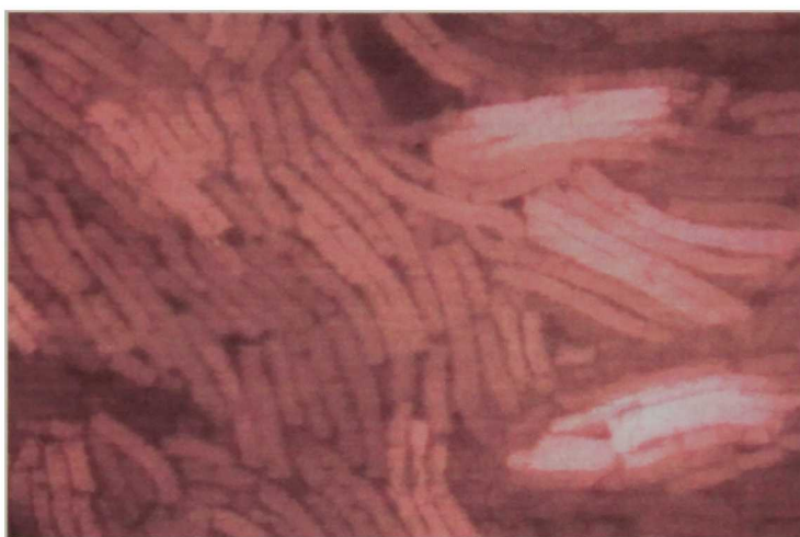
Figura 26. Corte transversal de filamentos obtenidos en pruebas realizadas con una esprea rectangular.
