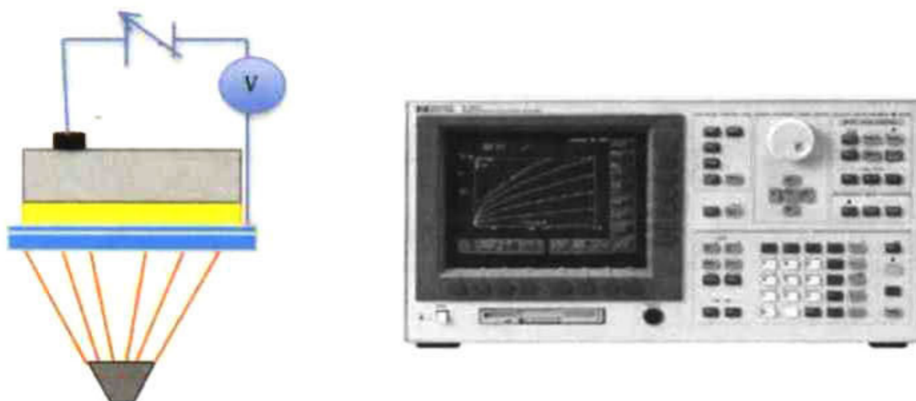
Figura 30. Diagrama que muestra la configuración del equipo para la caracterización de la celda, Semiconductor parameter Analyzer
