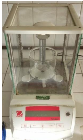
Figura 6.7. Balanza analítica y equipo empleado para la medición de la densidad de las muestras sinterizadas.
