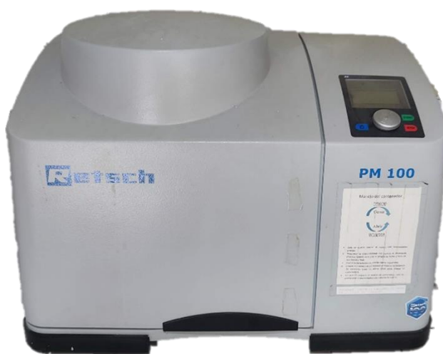
Figura 6.3. Molino Planetario de alta energía Retsch PM 100.
