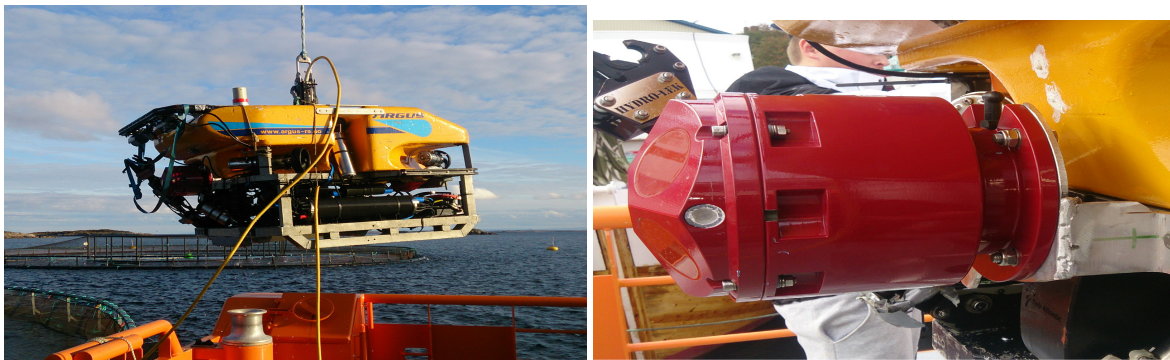
(a) Argus Mariner ROV utilizado en los experimentos, (b) DVL montado en la parte frontal de un ROV Argus levantado sobre la cubierta del buque de servicio de su- Mariner y red de acuicultura relativo al ángulo yaw y distancia del ROV.
