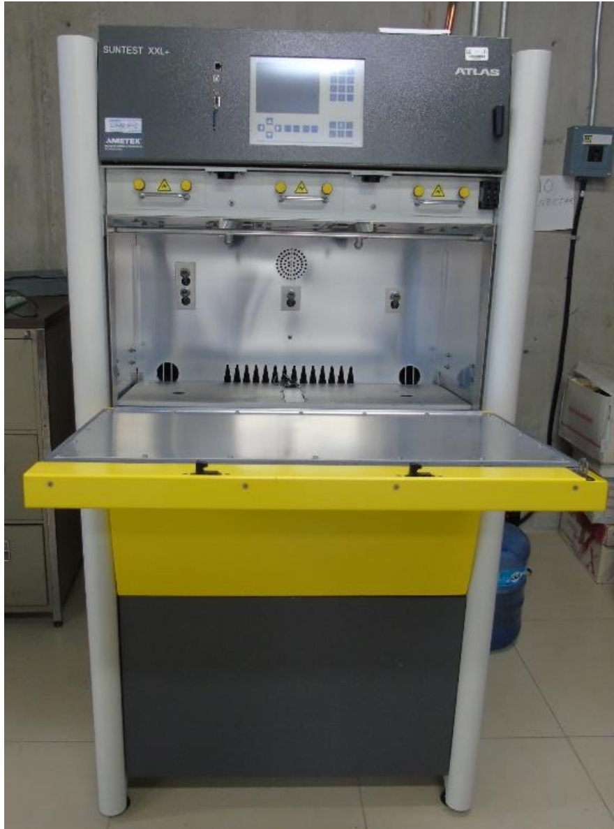
Figura 10. Imagen del equipo SUNTEST XXL + ATLAS utilizado para las pruebas de intemperismo acelerado.
