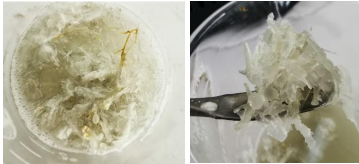
Figura 25. Sargazo tratado con peróxido de hidrógeno colocado a 65°C en agitación por 48 h.
