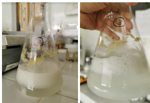
Figura 26. Sargazo tratado con peróxido de hidrógeno colocado a 65°C en agitación por 94 h.
