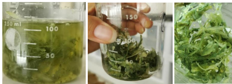
Figura 24. Sargazo tratado con hidróxido de sodio y posteriormente con ácido clorhídrico.
