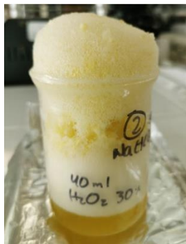
Figura 23. Sargazo tratado con hidróxido de sodio y posteriormente con peróxido de hidrógeno.
